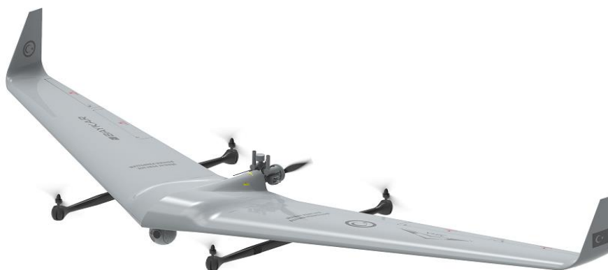
Εικόνα18. ΤοBayraktar DIHA της Baykar: ένα μικρό αεροπλάνο κάθετης απο/προσγείωσης, μέγιστου βάρους 50 kg. Μετά την απογείωση με την βοήθεια των 4 ηλεκτρικών κινητήρων του, τίθεται σε λειτουργία πλεύσης, όπου λειτουργεί μόνο ο κινητήρας εσωτερικής καύσεως, με μέγιστη ταχύτητα 80 knots και μέγιστο ύψος πτήσης 15.000 ft. Θα χρησιμοποιείται για αποστολές αναγνώρισης και συλλογής πληροφοριών.
