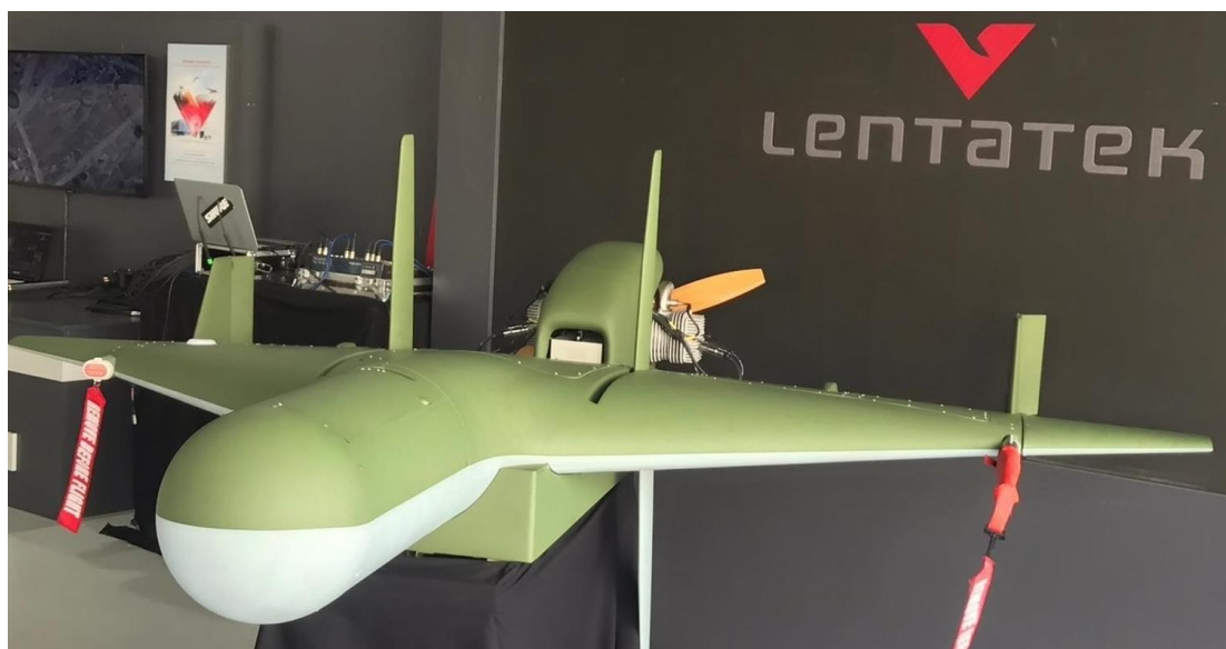
Εικόνα 20. Το περιφερόμενο πυρομαχικό Kargi της εταιρείας Lentatek, όπως παρουσιάστηκε πρόσφατα στην άσκηση EFES-2022 στην Τουρκία, για καταστολή και καταστροφή των εχθρικών ραντάρ. Οι ομοιότητες είναι κάτι παραπάνω από προφανείς με το Harry της IAI, το οποίο και πρόκειται να αντικαταστήσει ( https://www.dailysabah.com/business/defense/turkeys-new-kamikaze-uav-kargi-debuts-in-aegean-drill ).
