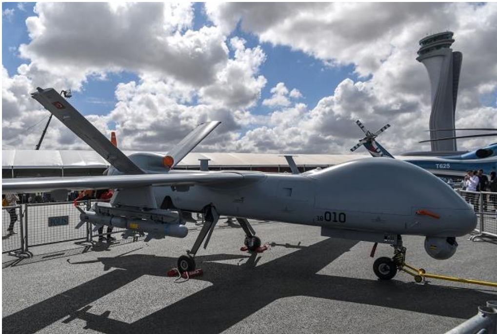
Εικόνα 9. Ένα τουρκικό TAI Anka οπλισμένο με κατευθυνόμενα όπλα αέρος-εδάφους ακριβείας MAM-L με εμβέλεια της τάξης των 10 km.
